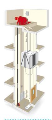
La energía tiene que ver con la fuerza y el movimiento. El motor del ascensor tensa el cable y hace subir la cabina, con su carga, a lo largo del pozo.
